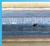
Trou unique dans la zone 3 : les paramètres de diminution du courant de soudage ne sont pas correctement réglés (autres défauts dans la zone 3, voir ci-dessous).
